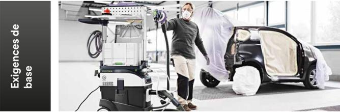
► Utilisez toujours un système d'extraction de poussières approprié et sélectionnez des outils adaptés au ponçage de l'aluminium : Festool Cleantec CTM 48 EC / B22 est certifié selon la directive ATEX 94/9/EG pour les zones 22.
